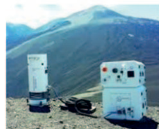
Gravimètre quantique de Exail
